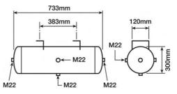
**50LTR AIR TANK SIDE MOUNTED 300mm x 765mm LG** SA1306 **£84**.21
